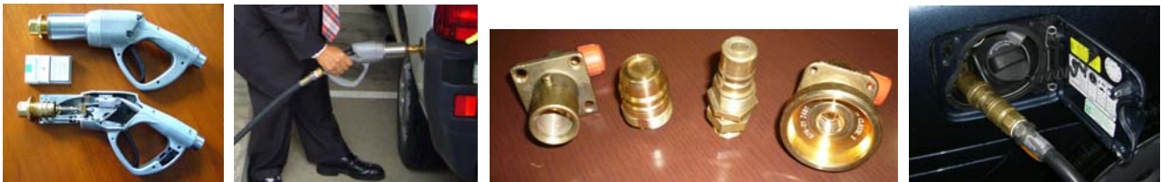
4.「ユーロノズル」片手で脱着可能で安全 5.中央右が日本仕様、中央左がユーロノズル 6.フタが開いていると始動しない
